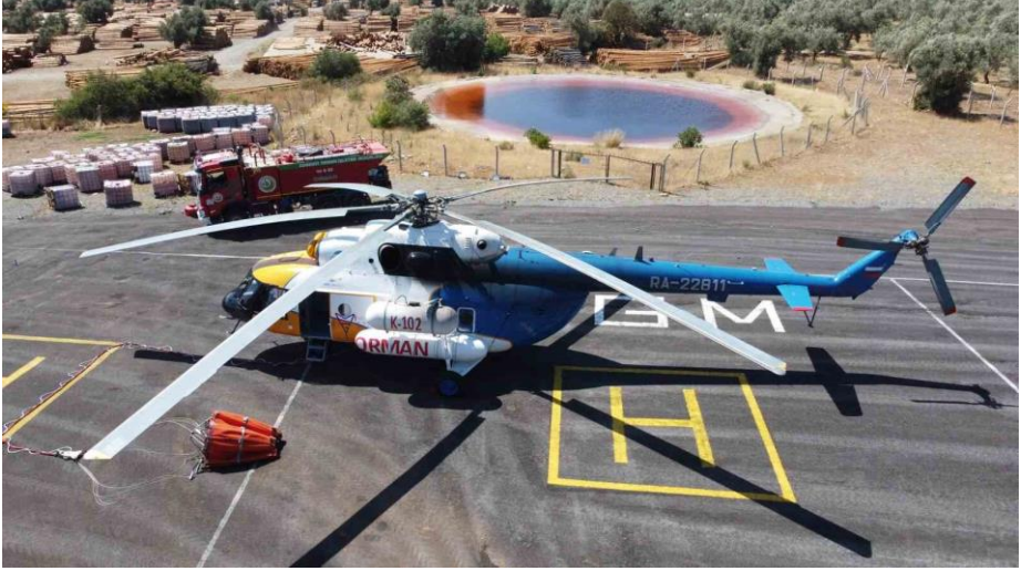
Şekil 7. Bambi Kova sistemleri (genellikle yaklaşık 2000 litre kapasiteli) kullanarak su taşıyan helikopterlerin kullanılması (OGM, 2026)
