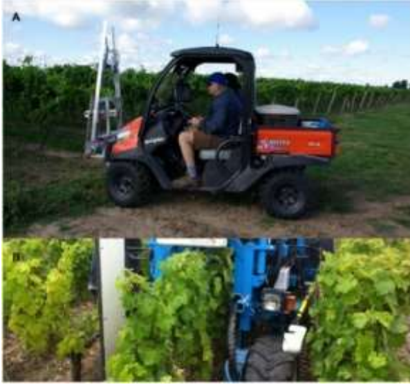
A-Motorlu araç ile Greenseeker sensörünün kullanımı B. Traktör ile Greenseeker sensörünün kullanımı Şekil 2. Greenseeker sensörü ile NDVI ölçümü
