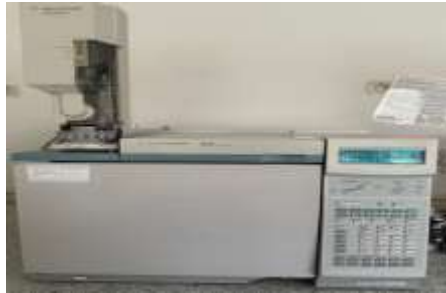
Şekil 1. Fındık zarı ve fındık kabuğundaki yağların yağ asidi analizinde kullanılan GC cihazı
