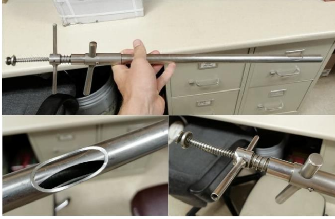
Şekil 4: Kimberling-Rupp Kısırlaştırma Aleti (Boisdon, 2023)
