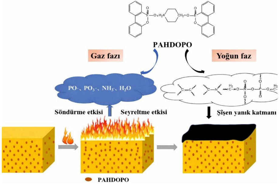
Şekil 4. Önerilen alev geciktirici mekanizmanın şematik diyagramı (Chen vd., 2023:30).
