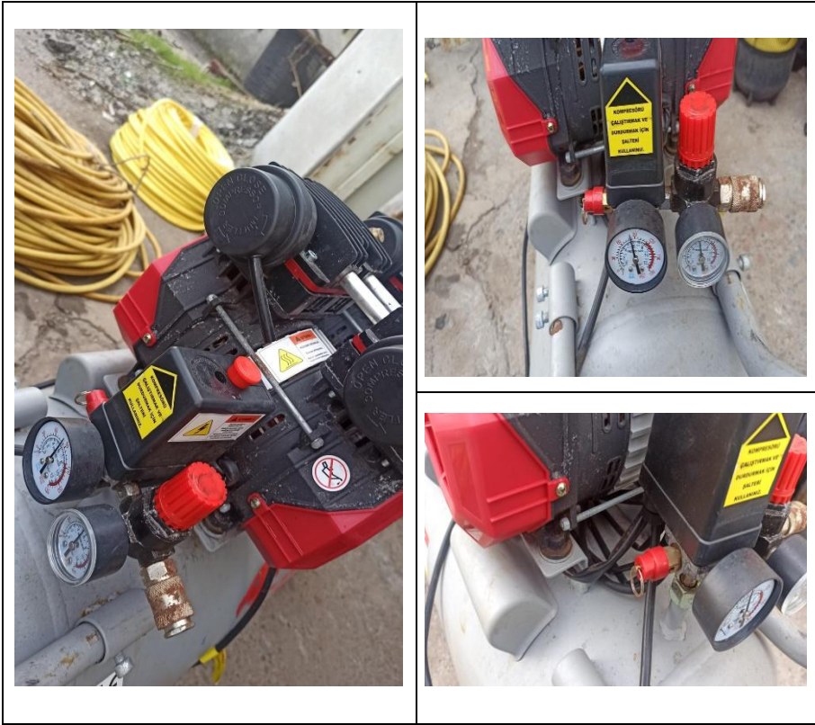
Şekil 5: Bağlantı ünitesi ve emniyet valfleri
