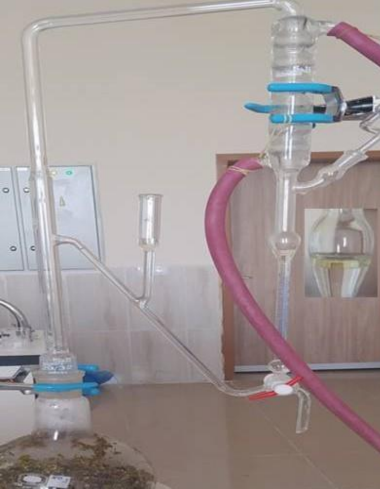
Figür 2. Clevenger aparatı ile hidrodistilasyon ve uçucu yağ eldesi
