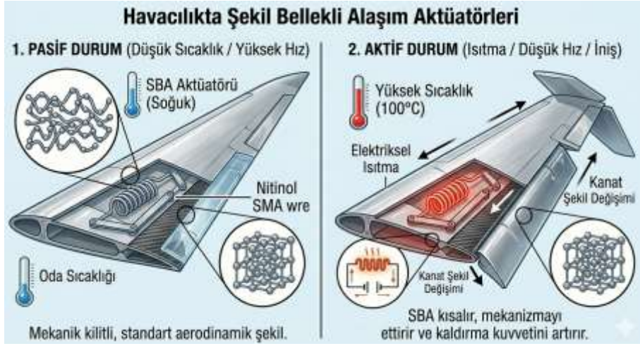
Şekil 4. Havacılıkta şekil bellekli alaşım aktüatörleri
