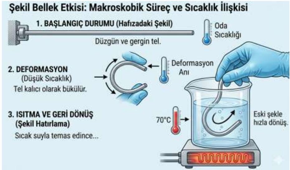
Şekil 2. Şekil bellek etkisi: Makroskopik süreç ve sıcaklık ilişkisi
