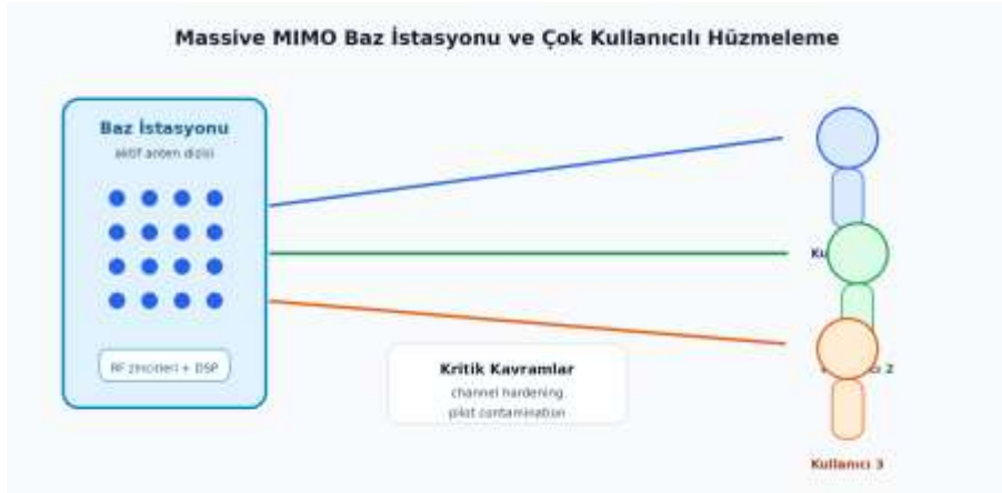
Şekil 3. Massive MIMO baz istasyonu mimarisi ve çok kullanıcı hüzmeleme yaklaşımı.
