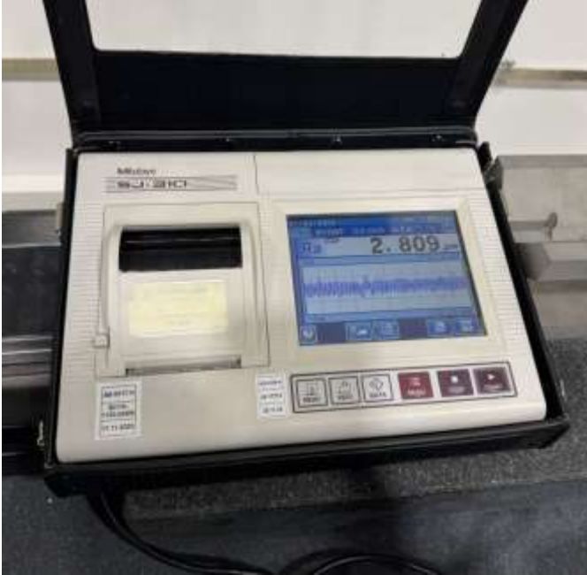
Şekil 4: Mitutoyo SJ-310 Yüzey Pürüzlülüğü Ölçüm Cihazı
