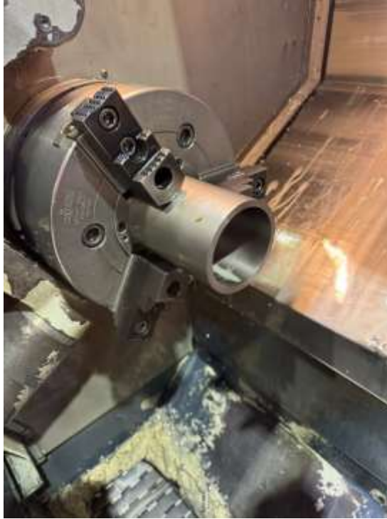
řekil 1: ASTM B394 NbZr1 Ham Malzeme ve Baęlama
