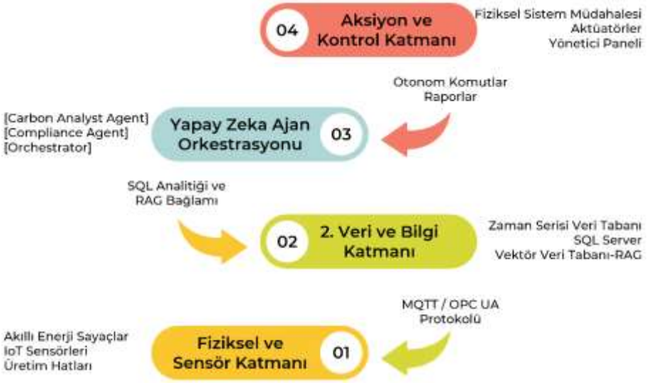
Şekil 1: Önerilen Sistemin Dört Katmanlı Yapısı
