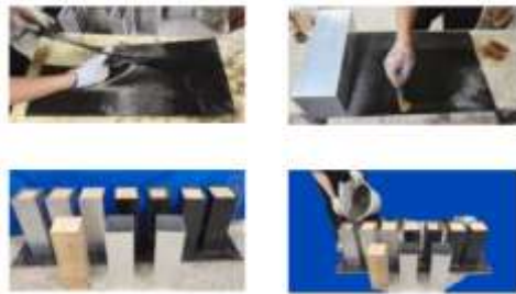
Şekil 2: Kolonların CFRP ile güçlendirilmesi
